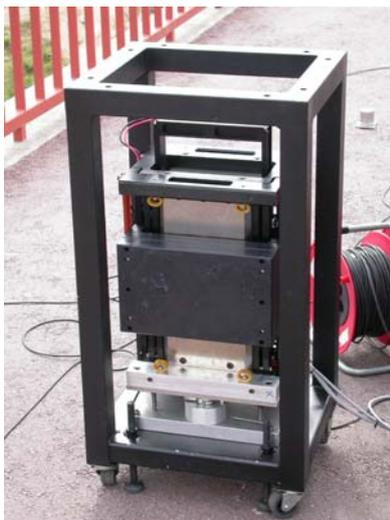
**Figure 5-2 : Vibrateur électromagnétique pour les applications de génie civil. Montage vertical**
