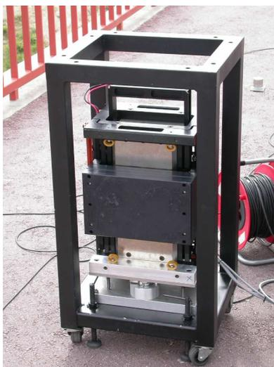
**Figura 5-2: Vibrador electromagnético para aplicações em engenharia civil. Montagem vertical**
