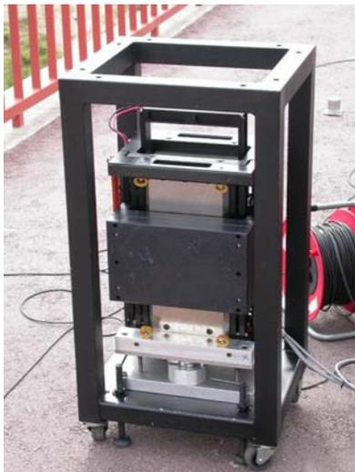
**Bild 5-2: Elektromagnetischer Shaker für das Bauwesen, vertikaler Aufbau**
