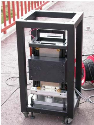
**Figure 5-2 : Vibreur électromagnétique pour les applications de génie civil. Montage vertical**
