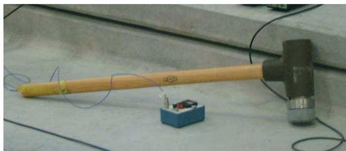
Figure 5-1 : Marteau à impact pour les applications de génie civil
