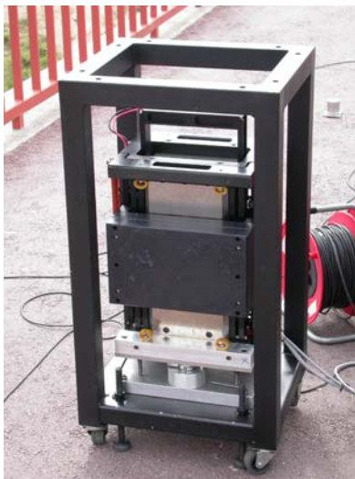
Figuur 5-2: Elektromagnetische vibrator voor civiel technische toepassingen. Verticale opstelling
