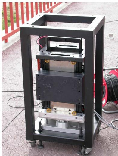
**Figura 5-2: Vibrador electromagnético para aplicações de engenharia civil. Montagem vertical**
