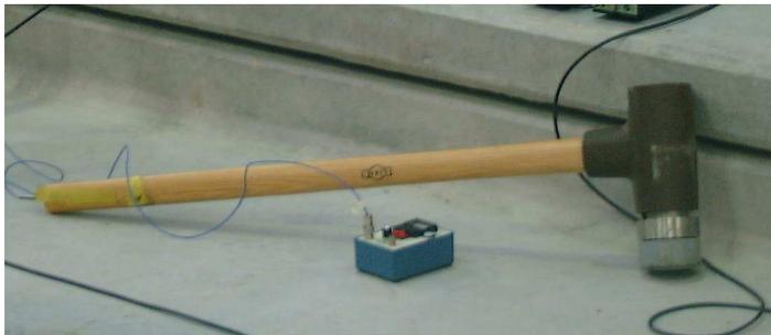
**Figura 5-1: Martelo de impulsos para aplicações de engenharia civil**
